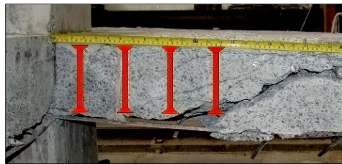
a) Esmagamento da biela (MAX) (Adaptado de LIPS, 2012)
